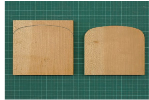
図7 ベースとなる木材、左：加工前、右：加工後。
