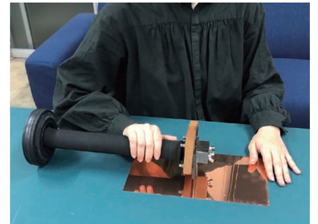
図14 WS型の補助具を動かしているところ。軽く揺らすと自然に前進する。
