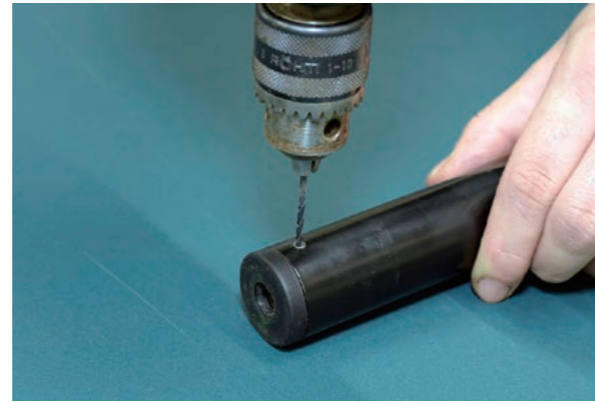
図5 スマートレグの片側だけに穴を開ける。
