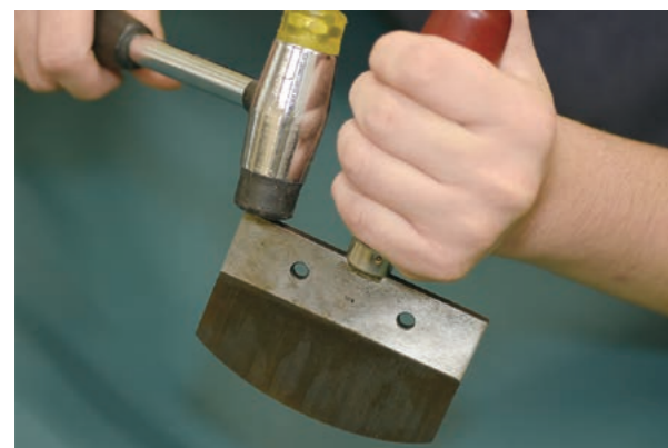
図4 ゴムのハンマーでベルソーの背を軽く叩くと柄から簡単に刃が外れる。
