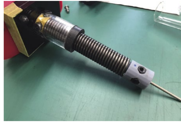
図13 Mk-IV Ver.3.1 可動部試作。中央の黒い部品は3Dプリンターで部品を作り、型取りにより、硬度15度のウレタン樹脂で置き換えたもの。
