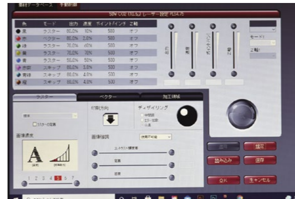
図6 レーザー加工機側のコントロールパネル。ここで深さや切断スピードをコントロールする。
