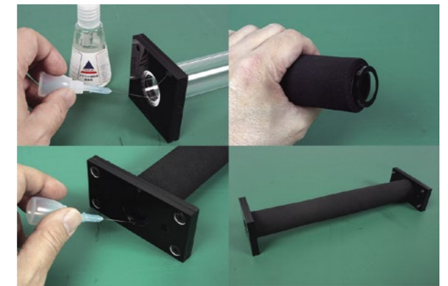
図10 左上：パイプに前部接合部をアクリル接着剤で固定する。右上：パイプにクッション材を入れる。左下：後部接合パーツをM5ボルトとナットで組み、パイプに接着する。右下：3パーツが組み上がったもの。
