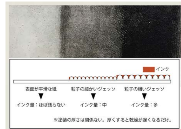
ジェツソアクアチントによる濃淡表現の原理
