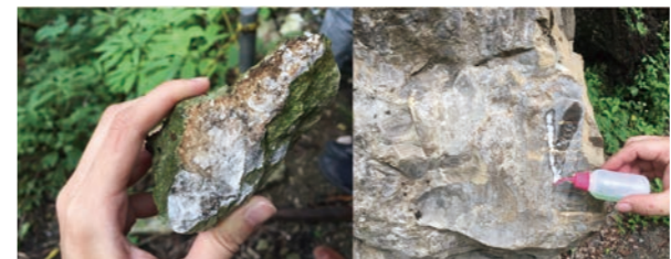
図5 石灰岩の断面と石が発泡した様子
