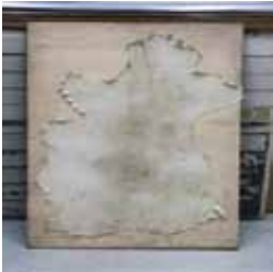
(図 14) 板張りして乾かす→→→
