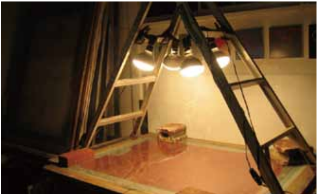
※栗田工業 AF-101、岩崎電機アイランプ PRF500W×4、クリップ付ソケット、脚立、アクリル板、重し用ブロック
