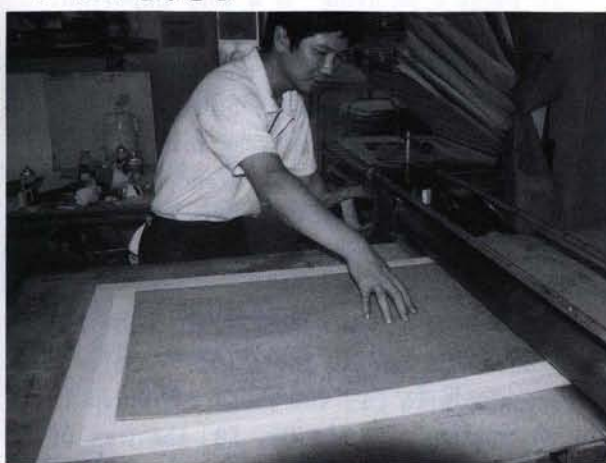
④プレス機のローラーの間を通す。その時、ローラーと版を閉口にせず少し斜めに入れるとスムーズに通る
